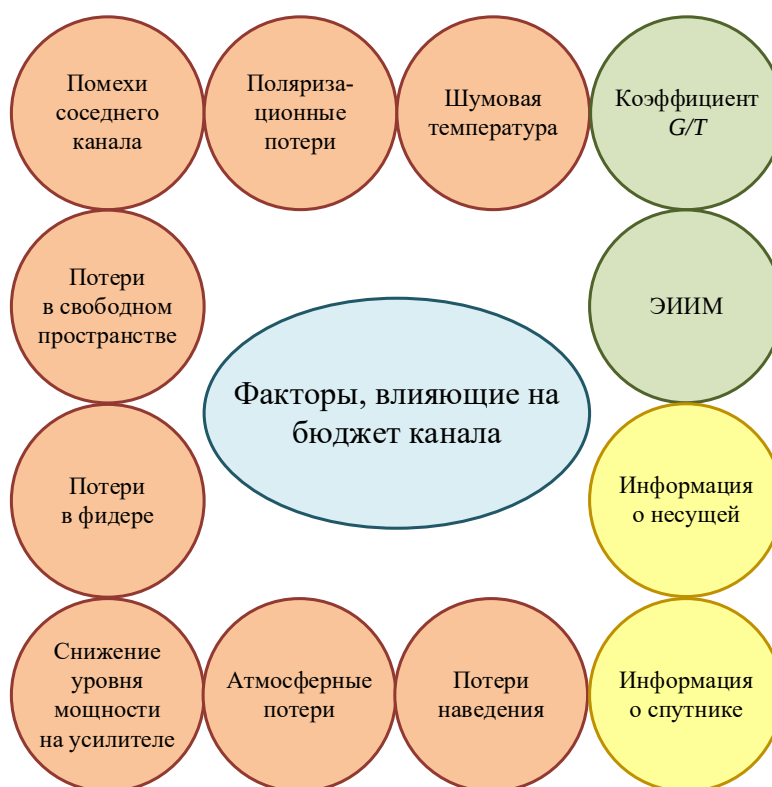
Рис. 3. Факторы расчета канала спутниковой связи
